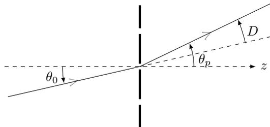
La méthode du minimum de déviation consiste à observer un minimum de  $D$  lors de la rotation du réseau, c'est-à-dire lorsqu'on fait varier  $\theta_0$ .
