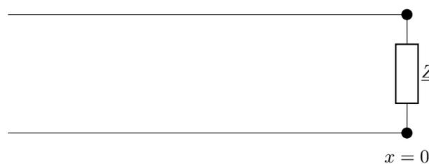
Calculer le coefficient de réflexion en intensité  $\underline{r} = \frac{\underline{I}^-}{\underline{I}^+}$ .
