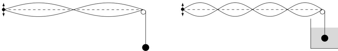
Dans un second temps, on immerge la sphère de masse  $m$  dans un récipient contenant de l'eau et on observe le schéma de droite.
