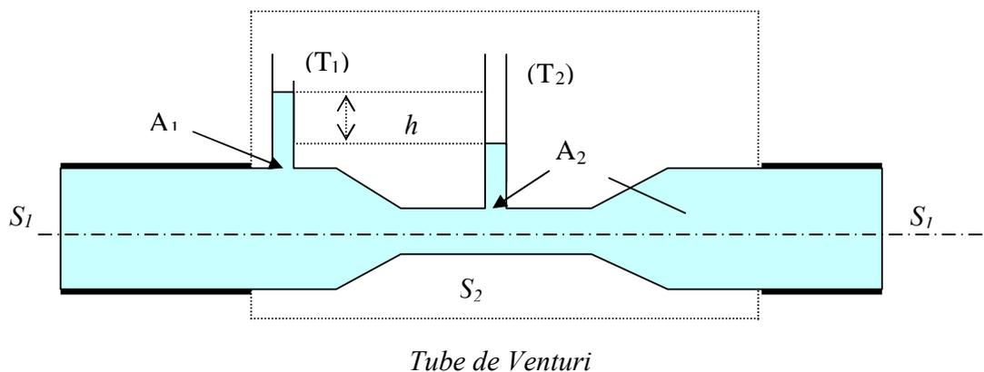
On note  $P_0$  la pression atmosphérique,  $P_1$  la pression et  $v_1$  la vitesse de l'écoulement en amont du tube de Venturi.  $A_1$  est un point à la base du tube ( $T_1$ ) et  $A_2$  est un point à la base du tube ( $T_2$ ).
