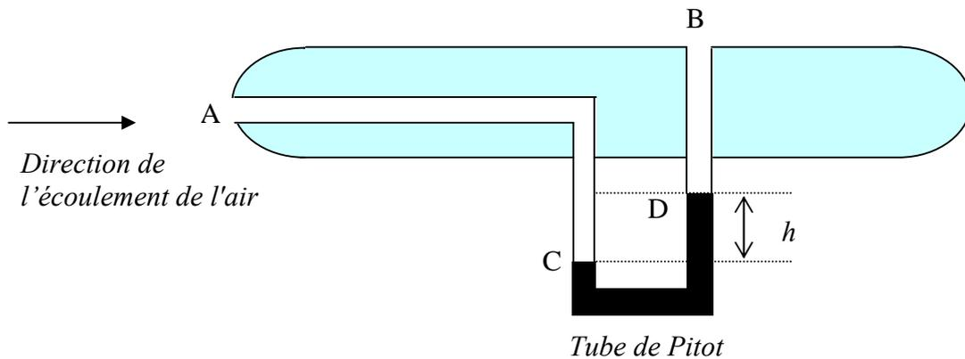
On considère que l'air est un fluide parfait, incompressible et en écoulement stationnaire, et que le dispositif ne perturbe pas l'écoulement.
