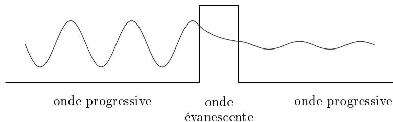
Pour le tracé, pensez que la fonction d'onde est continue ainsi que sa dérivée, donc il n'y a pas de points anguleux. L'amplitude de l'onde transmise correspond à celle de l'onde incidente, atténuée exponentiellement à travers la barrière.
