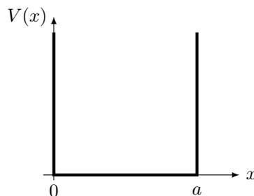
**Exemples.** Cela peut correspondre par exemple à un électron piégé dans une couche de semi-conducteurs AsGa entre deux couches de AsAlGa, qu'on synthétise facilement aujourd'hui grâce aux technologies de la nano-électronique. Ce potentiel peut aussi décrire un électron  $\pi$  sur une molécule linéaire (donc quasi-1D) conjuguée.
