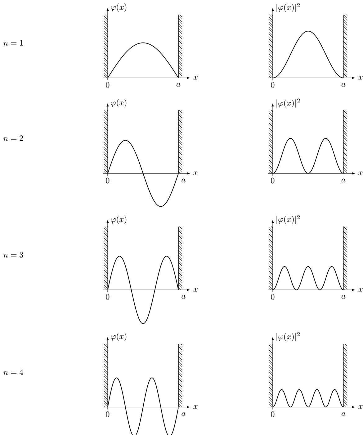
**Remarque.** On remarque l'analogie entre les états stationnaires d'une particule quantique dans un puit de potentiel infini et les modes propres d'une corde vibrante fixée à ses deux extrémités (voir le chapitre O2).
